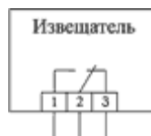
Схема подключения ИО 102-6П
