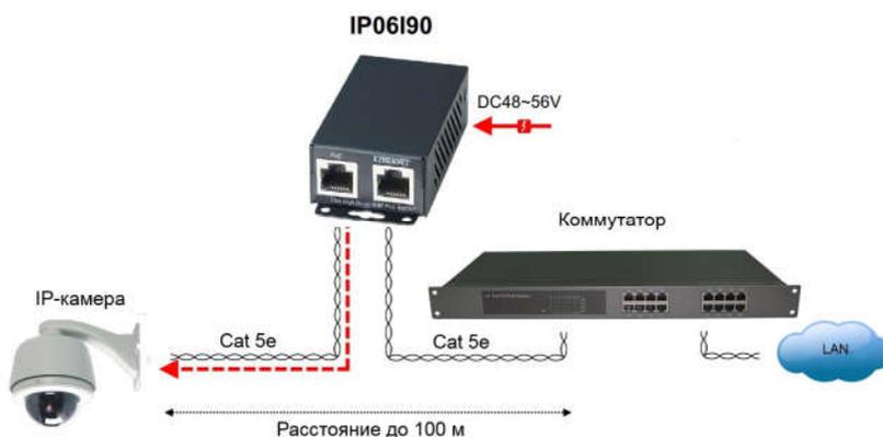
Рис.3 Схема подключения инжектора IP06190
