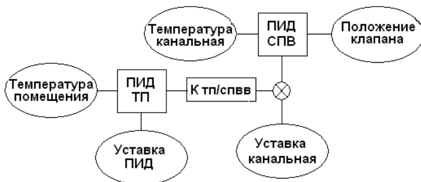
Рисунок 4.3 Каскадное регулирование в СПВ
