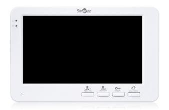
Монитор видеодомофонной связи ST-MS107-WT используется для реализации односторонней видеосвязи и двухсторонней аудиосвязи с панелями вызова по 4-х проводной линии. Этот монитор является простейшим устройством и поддерживает только базовый функционал. ST-MS107-WT совместим с панелями вызова ST-DS104C-GR, ST-DS206C-BK и ST-DS306C-SL, а также со сторонними панелями вызова при использовании устройств сопряжения.
