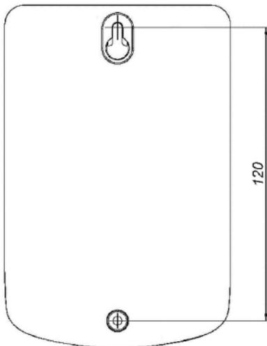
Расположение отверстий для крепления на основании оповещателя.
