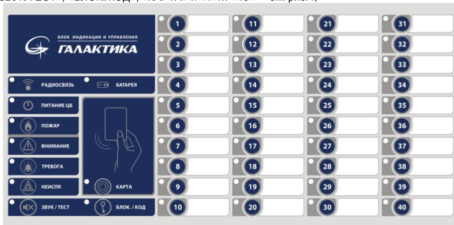
Рис.4 Внешний вид панели индикации и управления БИУ-Р2 ГАЛАКТИКА
