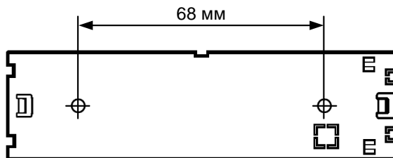
Рис.14в Основание Термо-Р2. Присоединительные размеры
