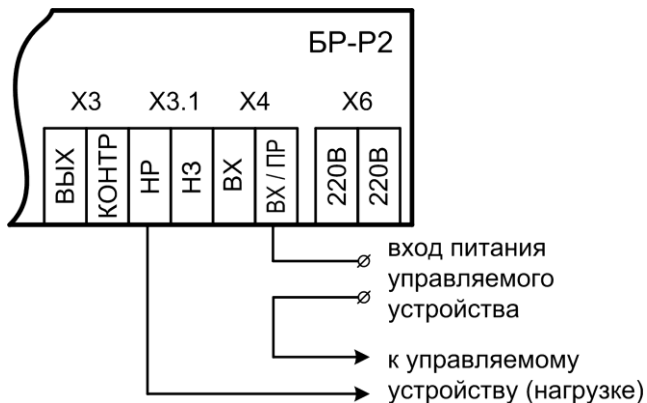
Рис.22 Схема подключения для функциональной проверки работоспособности БР-Р2
